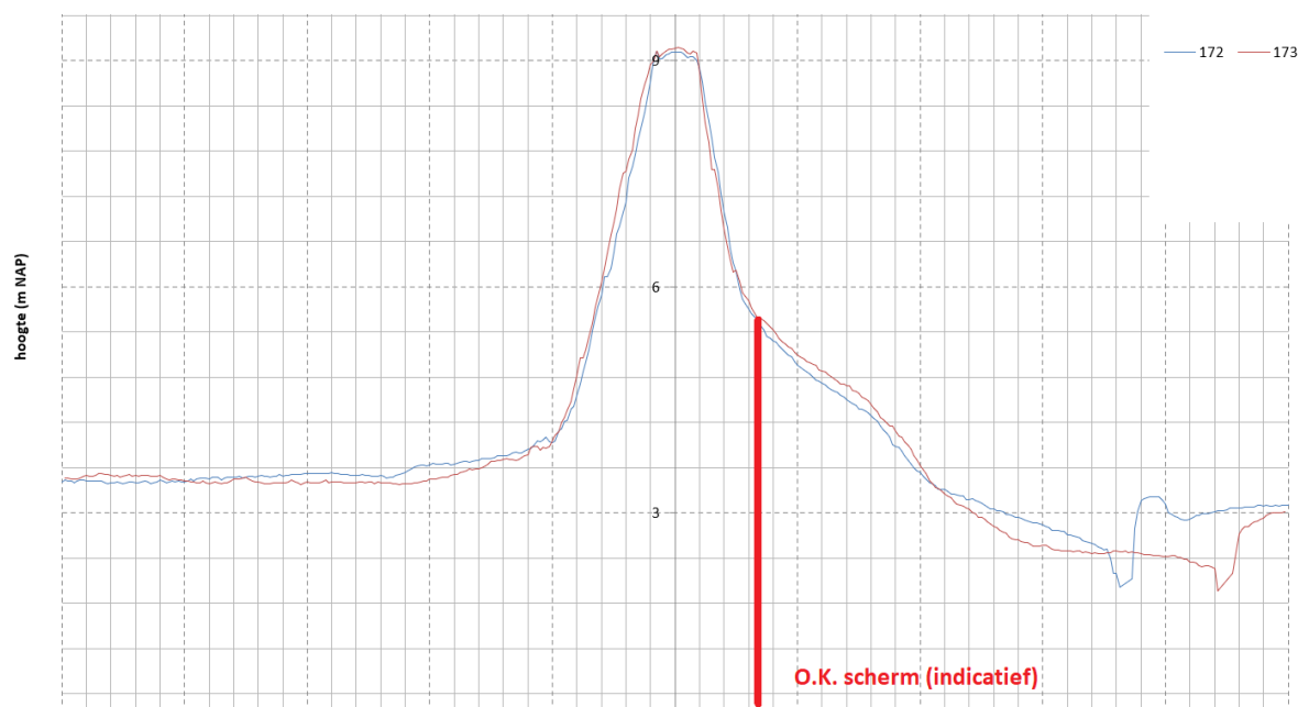
Figuur 6-3: Schematisering afmetingen heavescherm maatwerklocatie 2b.
