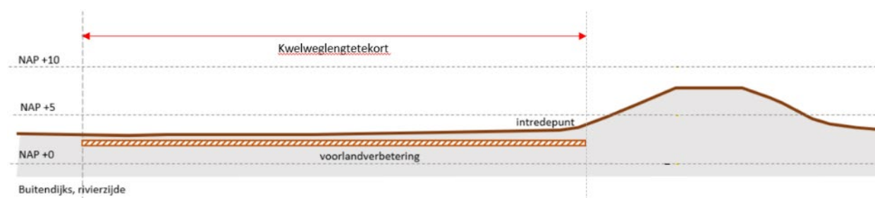
Figuur 6-9: Definitie afmetingen voorlandverbetering.
